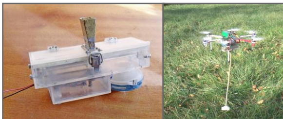
Рисунок – Внешний вид пробоотборника ПСЛ-2 и его установка на мультикоптере
